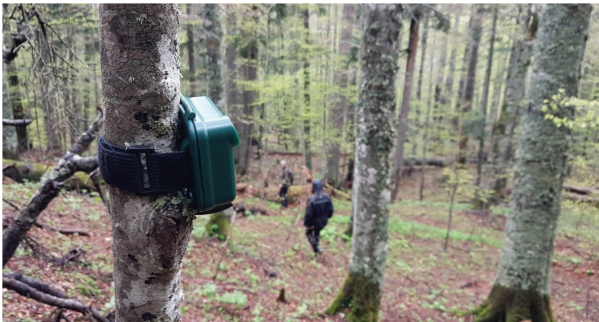
Pozicioniranje Audiomoth akustičnih registratora
