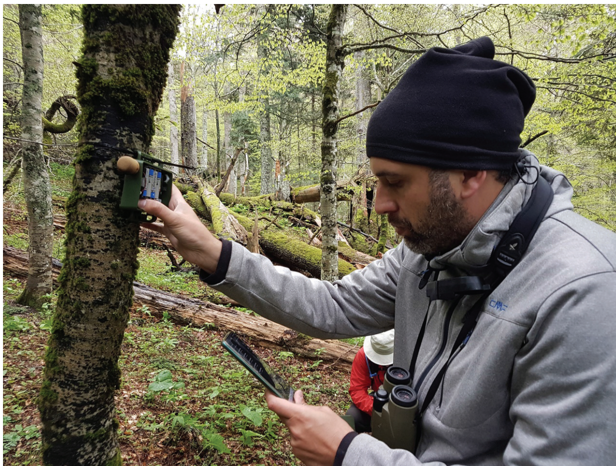
Osmatračke tačke i pozicioniranje Audiomoth registratora zvuka
